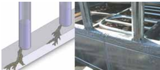
Figura 9 Effetto dei fori di diametro sottodimensionato
