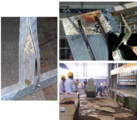
Figura 8 Esplosioni per mancata foratura dei pezzi: distruzione degli articoli e danneggiamento dell'impianto di zincatura
