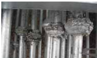
Figura 37 Esempio di difetto su particolari fucinati per la presenza di scoria resistente al decapaggio
