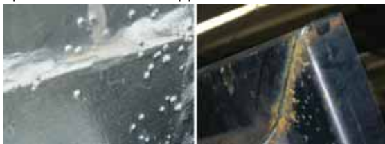
Figura 29 La zincatura esalta i punti in rilievo degli spruzzi di saldatura
