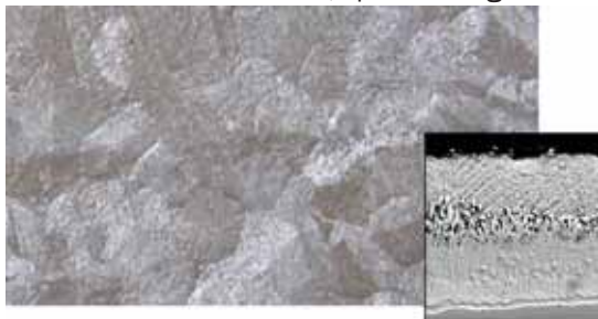
Figura 4 Aspetto e sezione al microscopio del rivestimento di zincatura su acciaio a basso contenuto di silicio e fosforo
